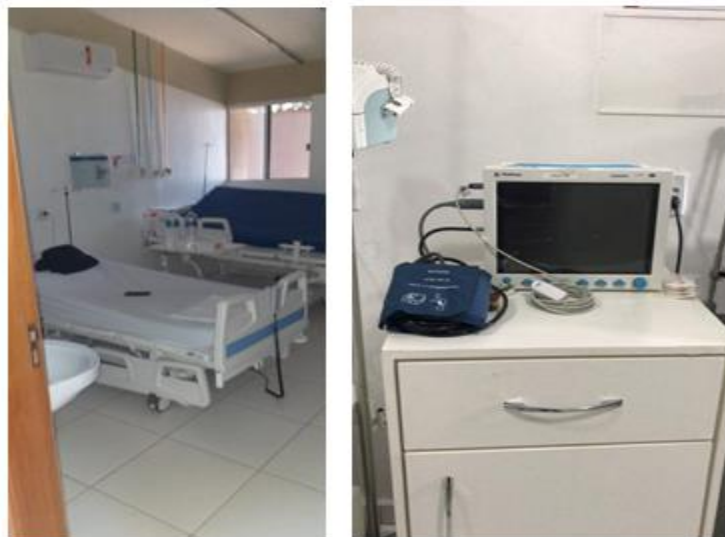
Figura 11. Camas elétricas e monitor multiparamétrico nos leitos de internação, é realizado calibração e ensaio de segurança elétrica anualmente.
