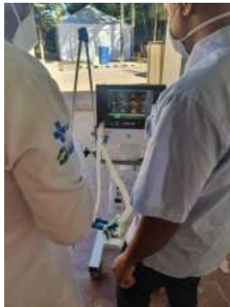
Figuras: 27 e 28 - Calibração e ensaio de segurança elétrica de ventiladores mecânicos
